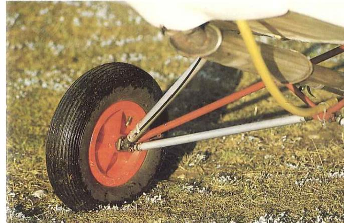
Der Prototyp ist noch ohne Bremse am robusten Hauptfahrwerk
